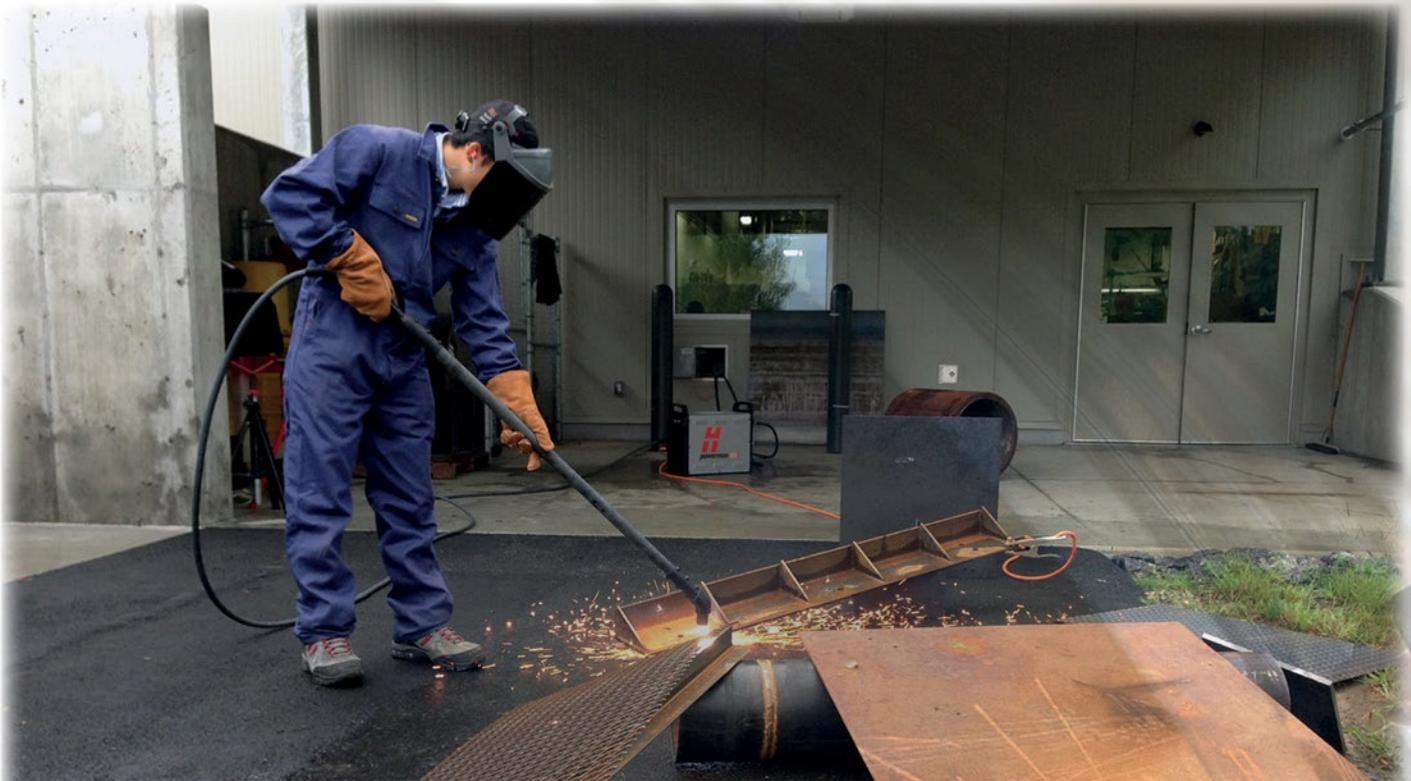
**Plasmaschneidbrenner, manuell, extra langer Brennerhals, Schneiden und Fugenhobeln • Duramax Hyamp 0.6 m**
