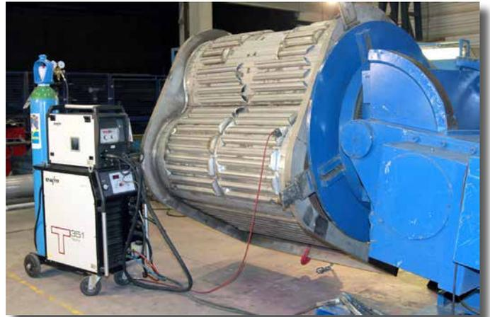
Die Kombination aus WIG-Heißdraht und tigSpeed reduziert bei AST die Schweißzeit um 40 Prozent.
