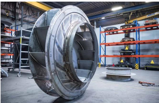
Ein geschweißtes Lüfterrad mit 3,5 Meter Durchmesser. Inclusive der Versteifungsringe befinden sich hier über 60 Meter Schweißnähte in dem Bauteil.
