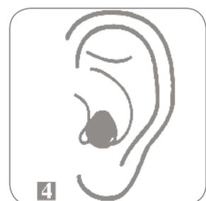
4 Anschließend Ohrstöpsel anfassen und Sitz kontrollieren. Es darf nur das Stöpsel-Ende zu spüren sein.
