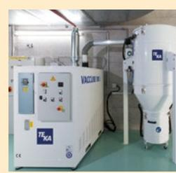
Mit bis zu 18,5 kW Leistung ist die VACCUBE 185i die leistungsstärkste Hochvakuum-Anlage im Sortiment. Geeignet für bis zu 10 Arbeitsplätze.
