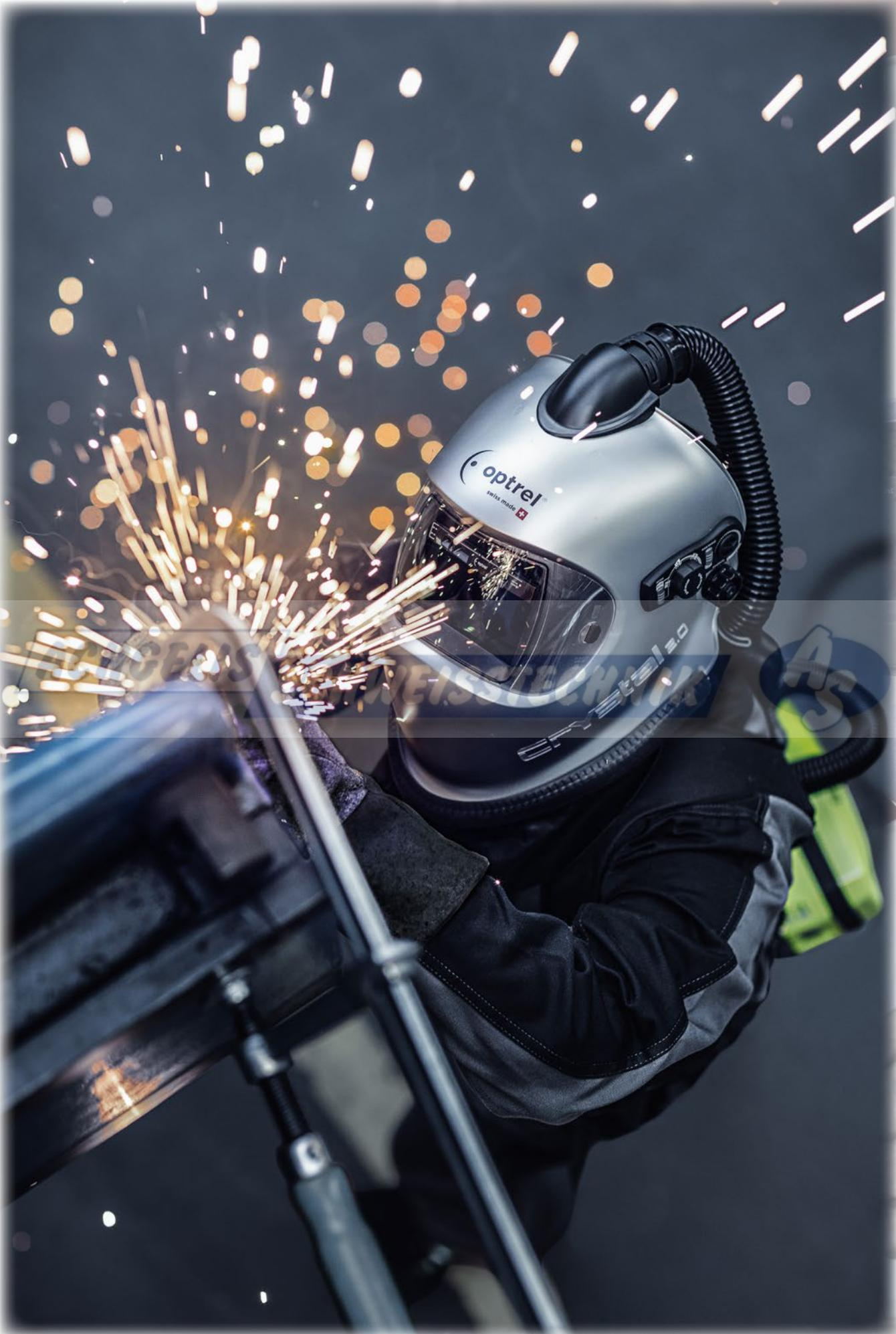
**Automatischer Schweißhelm • optrel weldCAP RC 3/9-12**
