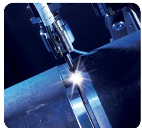
Orbitalschweißfahrwerk des Typs Polysoude Polycar
