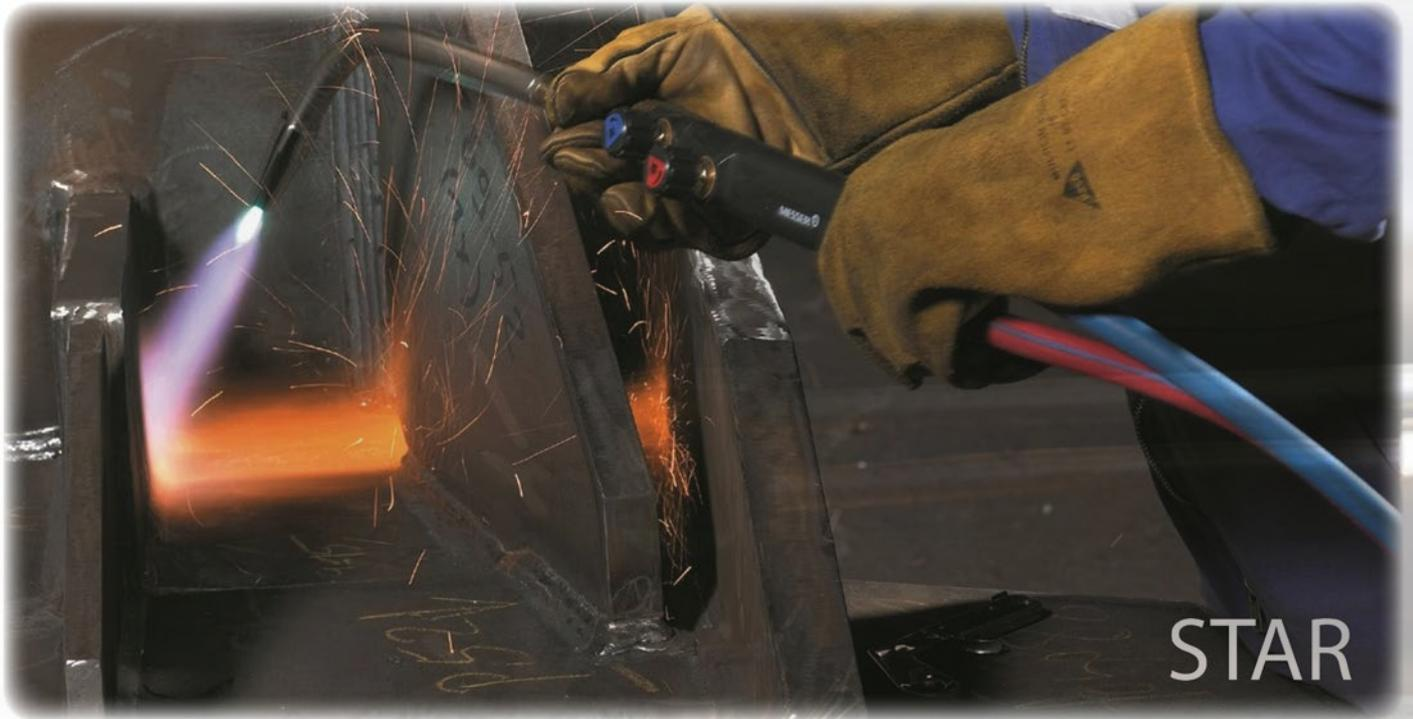
**Komplett-Garnitur für Brenngas Acetylen, mit Schlitzdüsen • STAR A**
